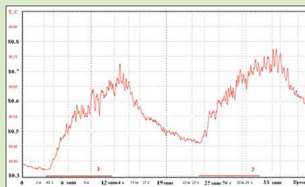
Рис.4. Тепловая обработка призабойной зоны. Изменение температуры напротив пласта с течением времени.
