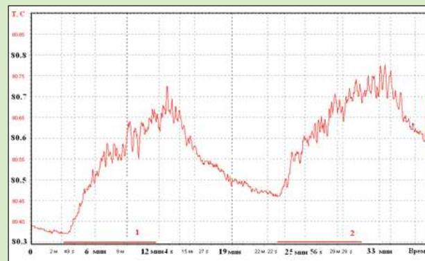
Рис.3. Изменение температуры в точке при двукратном локальном индукционном нагреве при наличии заколонного перетока «сверху». 1,2- интервал времени первого и второго нагрева.
